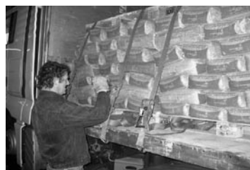
Bild 3: Fahrzeug ohne nachgewiesene ausreichende Festigkeit der Seitenwände, Paletten ohne Folienumhüllung – Niederzurren mit 2 Gurten je Palettenreihe, Hölzer oder Kantenschutz auf den Kanten
