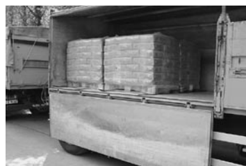
Bild 1: Fahrzeug mit Schüttgutaufbau – kein Niederzurren erforderlich
