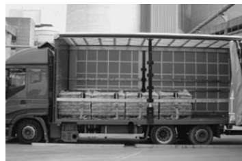
Bild 2: Fahrzeug mit Schiebepan, Paletten mit Folienumhüllung – Niederzurren mit 1 Gurt je Palettenreihe, Hölzer oder Kantenschutz auf den Kanten werden empfohlen
